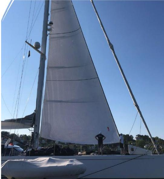
Eine sinnvolle Verbesserung für stärkeren Wind könnte ein frei fliegendes Kuttersegel sein, dass über ein zweites Fall unterhalb des Vorstags bedient wird. Über dieses Fall und einen angebauten Furler kann das Segel ohne zusätzliches Stag eingesetzt werden. Für größere Boote liegen gute Erfahrungen mit dem Kuttersegel vor.
