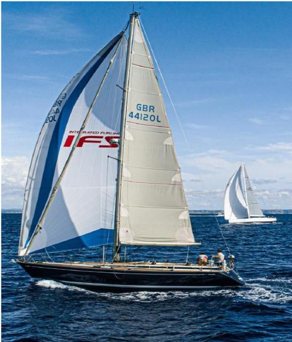
Möglich wird dies durch den Ersatz starrer Kabel in der Vorliek durch ein Netz von strukturellen Fasern, die ins Segel integriert sind. Vorteile liegen u.a. im geringeren Gewicht und geringeren Packmaßen sowie beim Handling des gerollten Segels an Deck. Durch die Fasern verteilen sich die Kräfte besser, Lasten an den Fallen werden um ca. 30-35% reduziert.
