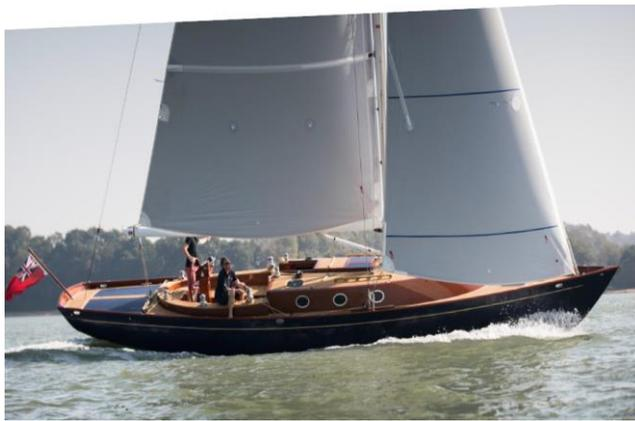
Die Umkehrung der vorherigen Empfehlung der Segelflächenverteilung wird bei diesem Schiff durch den konstruktiven Versatz des Mastes zum Bug hin möglich. Hier wird stärker mit dem Trimm des Großsegels gearbeitet. Es verfügt deshalb auch über mehr Möglichkeiten zur Flächenveränderung. Das Vorsegel ist vom Tuch her stärker ausgelegt
